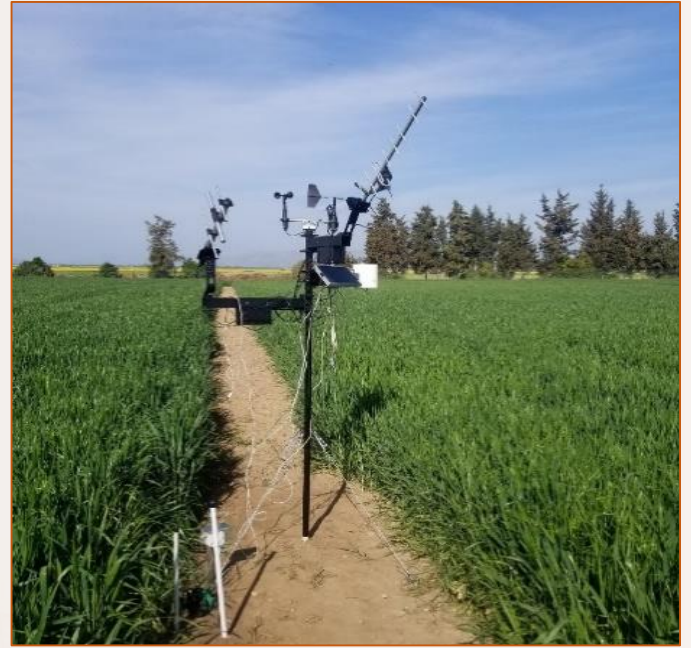
محطة الطقس وأجهزة الاستشعار متصلة بـ IoT Satellite
